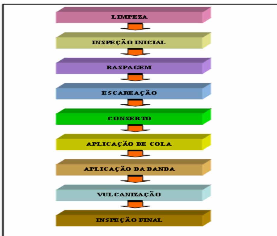
Figura 2 – Fluxograma do processo de reforma de pneus
