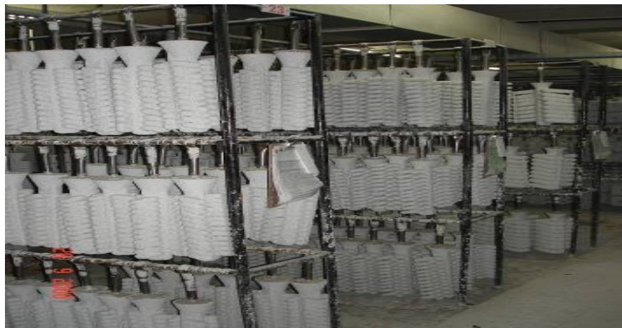
Figura 5: Cachos após o último banho de casca cerâmica
