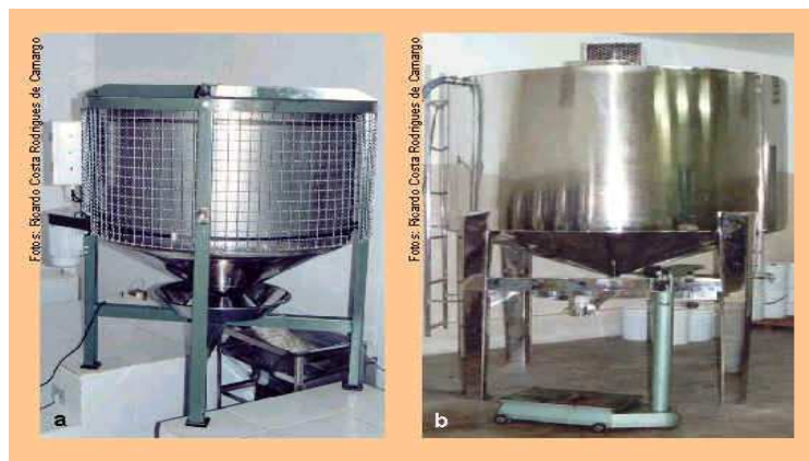
Figura 3 – Centrífuga (a) e tanque homogeneizador (b) na extração e processamento do mel: Fonte: CORRÊA, 2003
