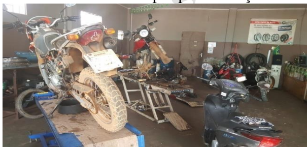
Estrutura de rampas para elevação.
