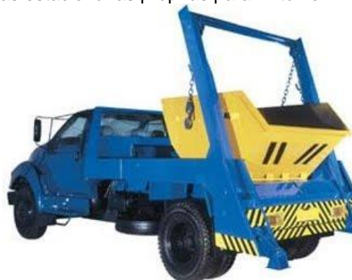
Caminhão Poli Guindaste para transporte de Caixas estacionárias próprias para Entulho
